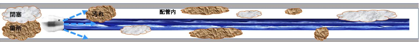
機械的に水に圧力をかけて、ノズル後方から水を噴射させ、その反作用によりノズル自体を自走させて、管内の閉塞箇所や汚れを剥ぎ取りながら、洗い流して進んでいくイメージです。ホースを押し込んだり、ねじったり、また、特殊なノズルを使用して、配管内をくまなく洗浄していきます。このような排水管清掃に必要な製品を当社は製造、販売しております。
